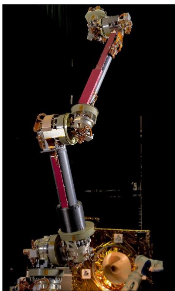
Рис. 2. Один из манипуляторов Restore-L [16]
