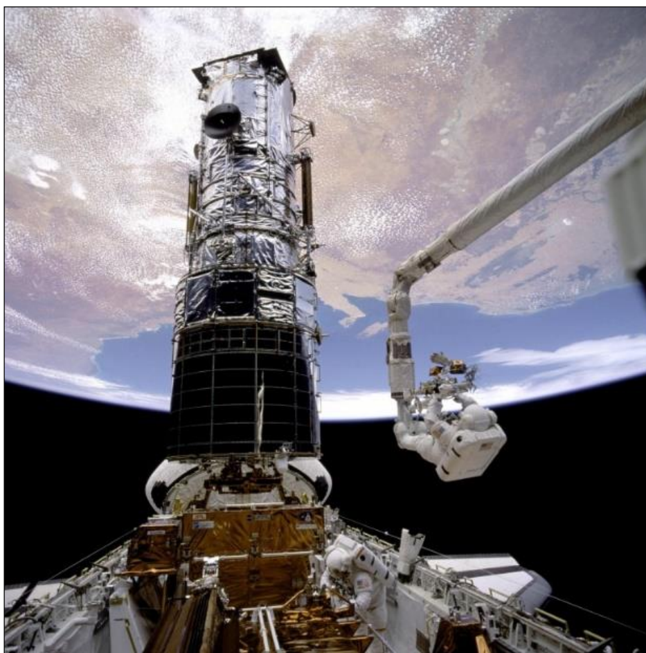
Рис. 4. Обслуживание телескопа «Хаббл» с помощью манипулятора Canadarm L [16]
