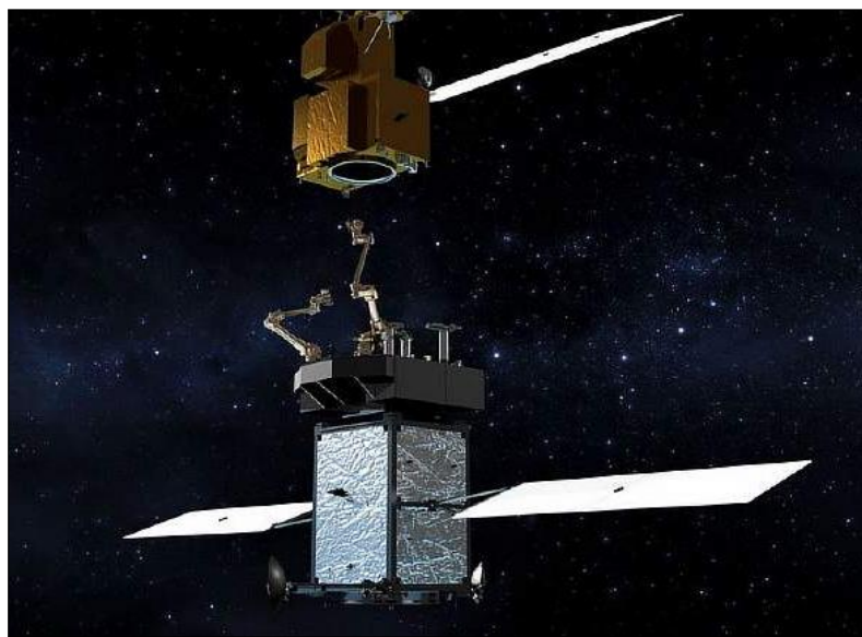
Рис. 3. Имитированная стыковка Restore-L и Landsat-7 L [16]
