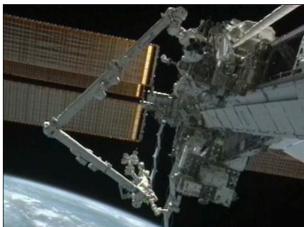
Рис. 1. Стыковка манипулятора «Декстр» и заправочного модуля RRM [5]
